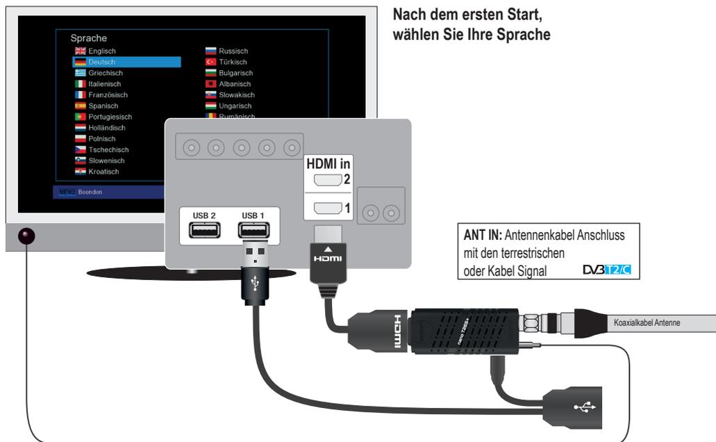
ANT IN: Antennenkabel Anschluss mit den terrestrischen oder Kabel Signal **DVB-T2/C**
