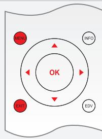
Πιέζοντας το πλήκτρο MENU εμφανίζεται το κεντρικό μενού. Πλογηθείτε μεταξύ των σημείων με τα βέλη και το πλήκτρο OK το χρησιμοποιείτε για να επιλέγετε. Με το πλήκτρο EXIT εγκαταλείπετε το παραθύρο των μενού.
