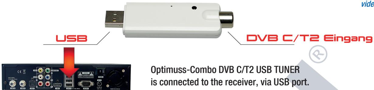
Optimuss-Combo DVB C/T2 USB TUNER
