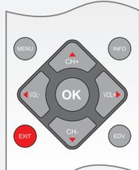
Πιέστε κατά τη λειτουργία της τηλεόρασης ή του ραδιοφώνου το πλήκτρο OK για να εμφανίσετε τη λίστα καναλιών. Χρησιμοποιήστε τα πλήκτρα με τα βέλη και το πλήκτρο OK για να πλοηγηθείτε στο μενού. Με το πλήκτρο EXIT κλείνετε τη λίστα.
