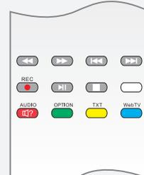
Ανάλογα σε ποια στήλη του μενού της λίστας καναλιών βρίσκεστε, μπορείτε να εμφανίσετε με τα εγχρωμα πλήκτρα περαιτέρω λειτουργίες και μενού. Οι πιθανές λειτουργίες εμφανίζονται στην κάτω πλευρά του πεδίου.
