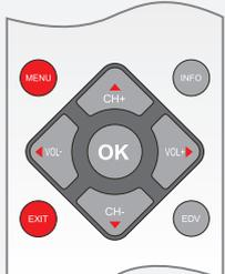
Πιέζοντας το πλήκτρο MENU εμφανίζεται το κεντρικό μενού. Πλοηγήστε μεταξύ των σημείων μενού με τα βέλη και το πλήκτρο OK το χρησιμοποιείτε για να επιλέξετε. Με το πλήκτρο EXIT εγκαταλείπετε το παράθυρο των μενού.
