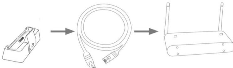
Para conectar la estación de acoplamiento a Internet, proceda de la forma siguiente:
