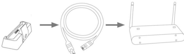
Aby połączyć stację dokującą z Internetem, wykonaj następujące czynności:
