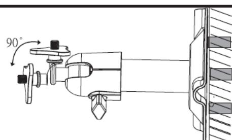
Finalmente, atornille la cámara al soporte y conecte la fuente de alimentación a la cámara.
