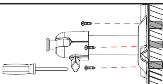
Tiene la posibilidad de girar 90° el soporte para fijar la posición que desee. A continuación, afloje el tornillo lateral y ajuste el ángulo de visión que dese; después, apriete el tornillo de nuevo para fijar la posición establecida.
