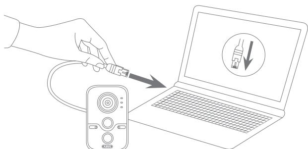
**Direkt anslutning av nätverkskameran till en PC/bärbar dator**
