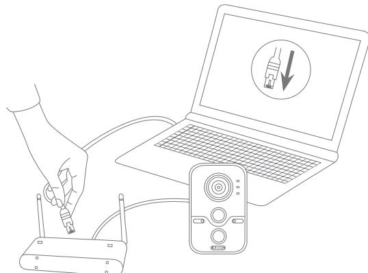
**Collegamento della videocamera di rete a un router/switch**
