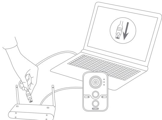
Anslutning av nätverkskameran till en router/switch
