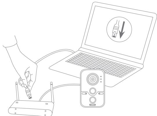
**Podłączenie kamery sieciowej do ruteru/przełącznika**
