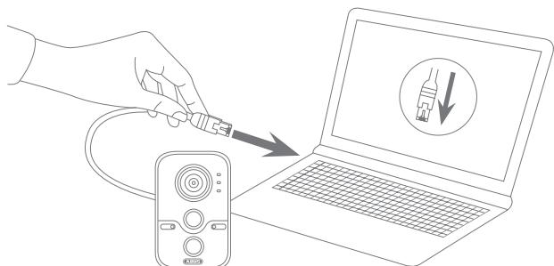
Direkte tilslutning af netværkskameraet til en pc/bærbar computer
