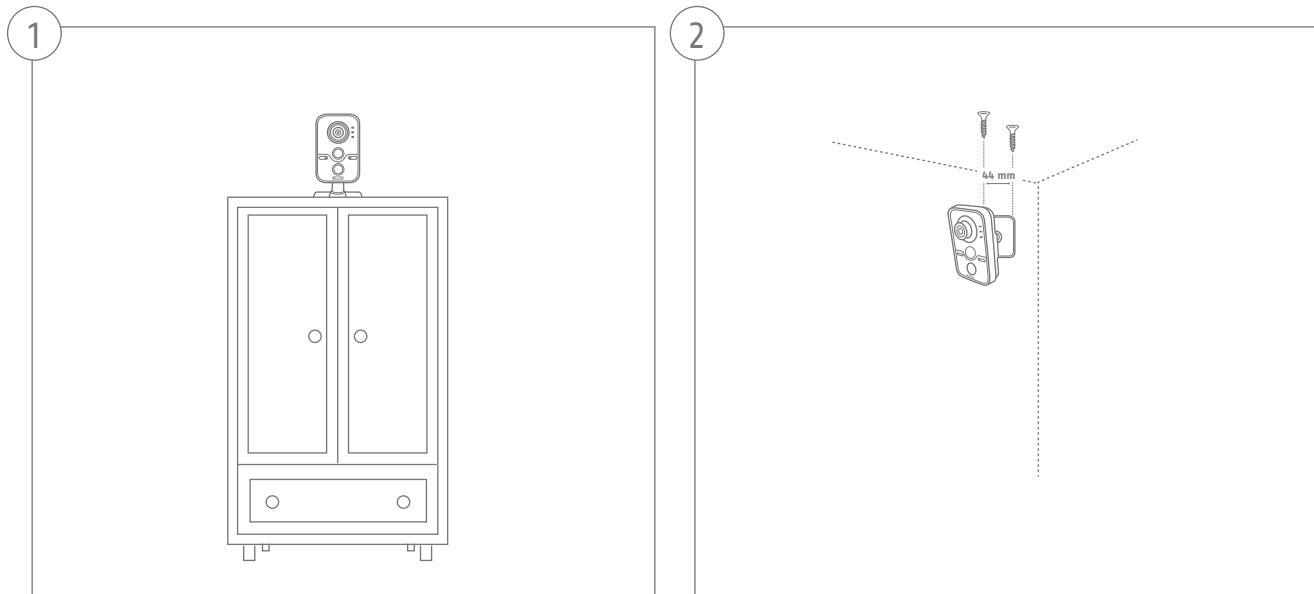
L'appareil peut être installé, au choix, par placement libre ou montage mural.
