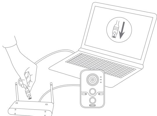
**Conexión de la cámara de red a un enrutador/conmutador**
