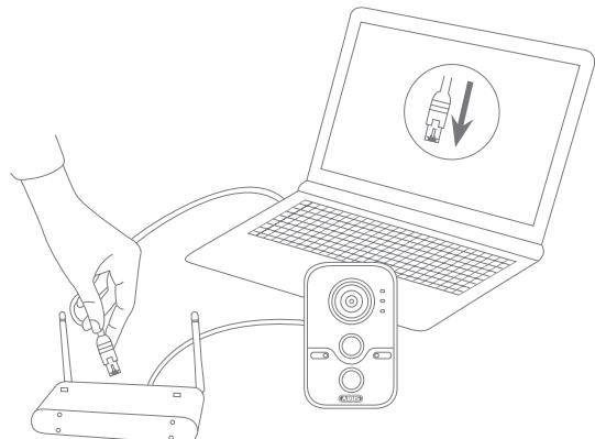
**Anschluss der Netzwerkkamera an einen Router/Switch**
