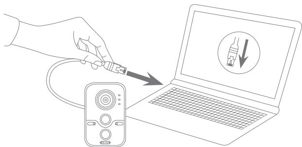
**Bezpośrednie połączenie kamery sieciowej do komputera PC/laptopa**
