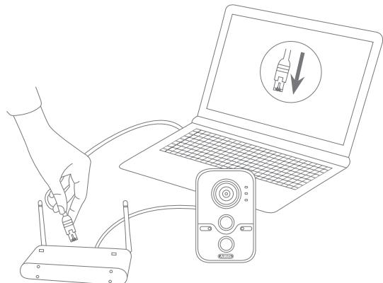
**Connexion de la caméra réseau à un routeur/commutateur**
