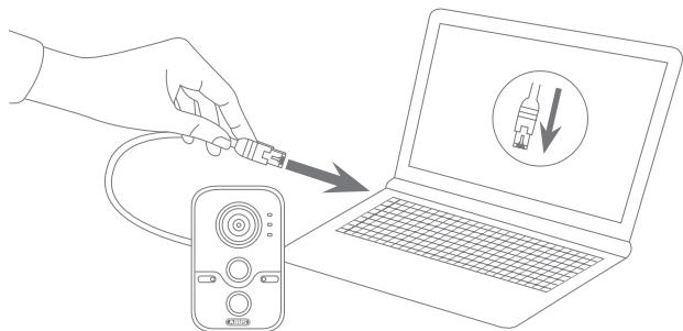
**Conexión directa de una cámara de red a un PC o portátil**
